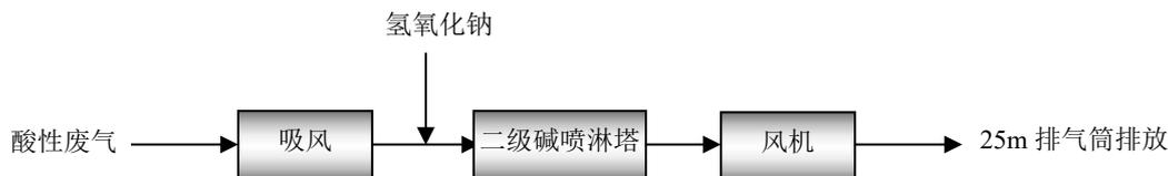
图 7.1-3 酸性气体处理工艺流程示意图
